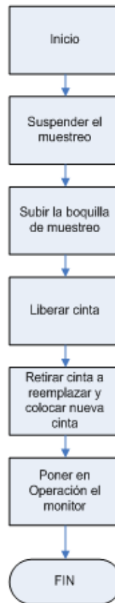
Figura 23. Proceso de revisión del analizador de material particulado PM10
